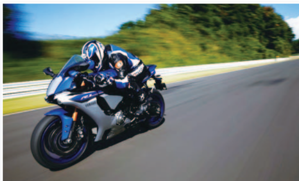
チタンコンロッド、アルミタンク、マグネリアフレーム、マグネホイールを採用したヤマハYZF-R1
